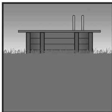
Installation semi-enterrée (sur dalle béton)
